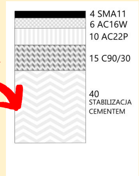
Konstrukcja zamienna ze stabilizacją cementem
